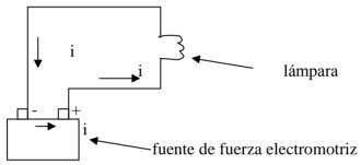
**INTENSIDAD DE CORRIENTE:** Es la cantidad de carga eléctrica (q) que pasa por una sección del conductor en la unidad de tiempo (t)
