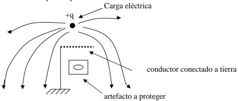
**PARARRAYOS:** Aplicación del efecto de punta y el fenómeno de inducción eléctrica.
