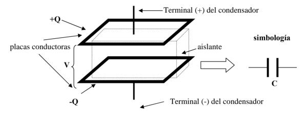
**CAPACIDAD C DE UN CONDENSADOR:** Es la cantidad de carga que se acumula en la placa positiva por unidad de voltaje entre las placas del condensador.
