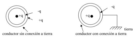
La tierra es capaz de ceder o admitir electrones. Si el conductor posee carga negativa y está conectado a tierra, los electrones del conductor se van a tierra. Sí el conductor posee carga positiva y está conectado a tierra, la carga positiva es neutralizada con electrones que vienen de la tierra.
