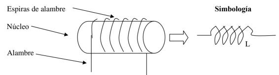
**INDUCTANCIA DE UNA BOBINA:** Es el voltaje que se crea en los extremos de la bobina o solenoide, cuando ésta es atravesada por una corriente que varía a razón de 1 ampere por segundo. La inductancia se mide en [Henry]
