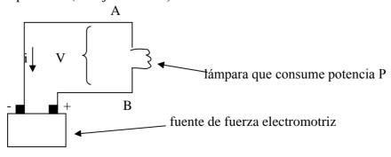
La diferencia de potencial V entre los puntos A y B de un aparato eléctrico, es la potencia P consumida en el aparato por unidad de corriente i consumida. El voltaje o diferencia de potencial entre los puntos A B del circuito, lo mantiene la fuente.
