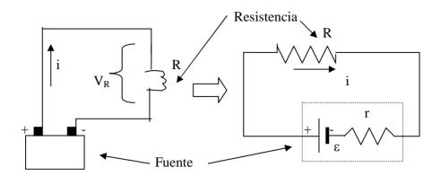
En que  $\varepsilon$  = fuerza electromotriz de la fuente,  $V_R$  = voltaje en la resistencia externa,  $V_r$  = voltaje en la resistencia interna, i = corriente en el circuito.
