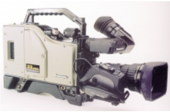
Videocámara de Panasonic basada en CCD y equipada con una grabadora de cinta D3. Utilizada en los Juegos Olímpicos de Barcelona, en 1992.
